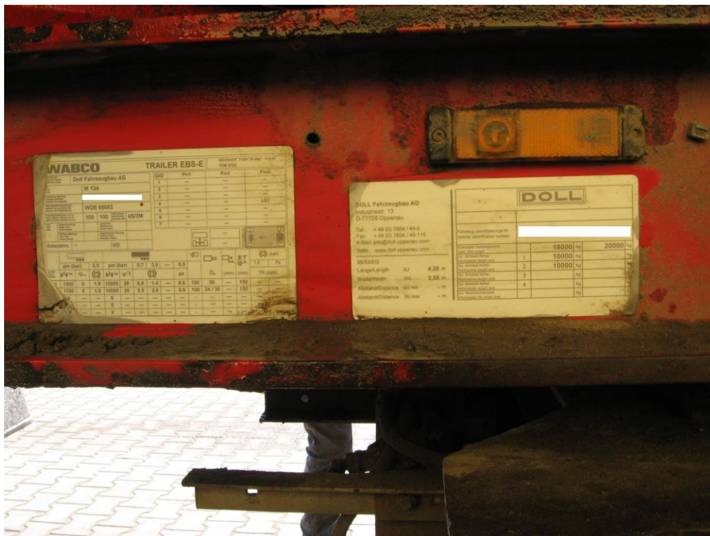
Fot. 4 - Zdjęcie przedstawiające oznaczenie pojazdu bez podanego numeru świadectwa homologacji typu WE pojazdu lub numer świadectwa homologacji typu pojazdu
